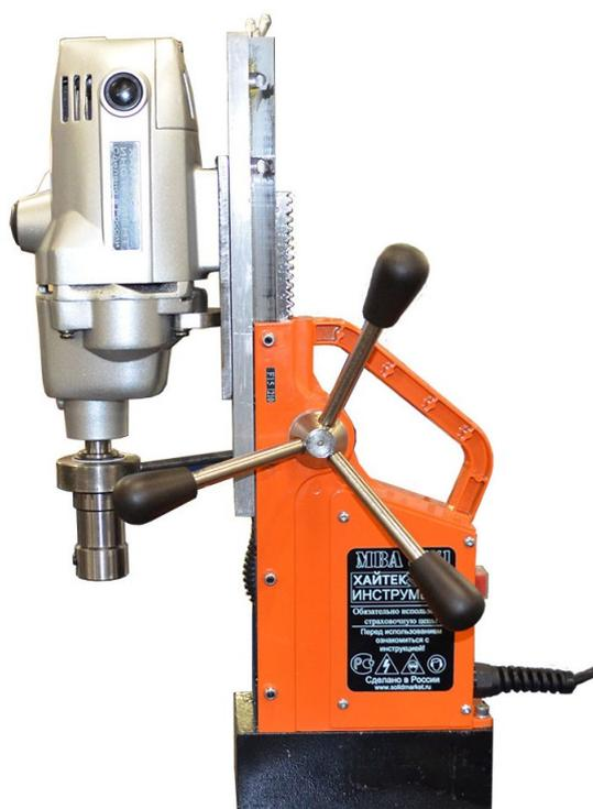
Диапазон сверления спиральным сверлом: 3-16 мм
