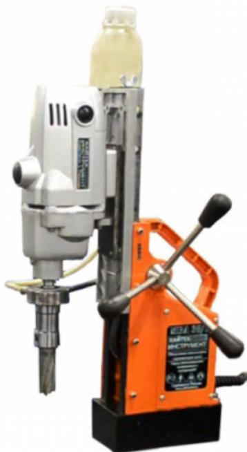
Диапазон сверления спиральным сверлом: 3-20 мм
