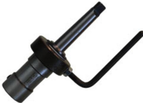
Держатель корончатых сверл с хвостовиком Weldon 19 для сверлильных станков с конусом Морзе 2, с подводом СОЖ. Предназначен для твердоплавных и быстрорежущих корончатых сверл длиной до 55 мм и диаметром до 55 мм.
