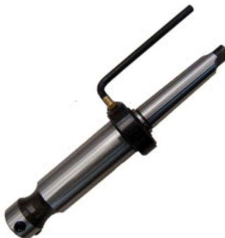
Держатель корончатых сверл с хвостовиком Weldon 19 для сверлильных станков с конусом Морзе 3 с подводом СОЖ. Удлинненный тип предназначен для твердоплавных и быстрорежущих корончатых сверл длиной 75, 85, 110 мм.
