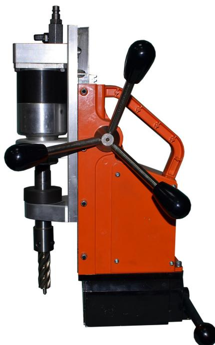
Диапазон сверления спиральным сверлом: 1-13 мм
