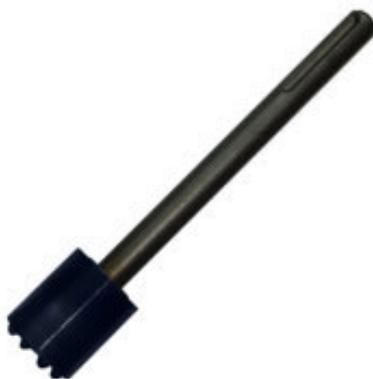
Для придания шероховатости камню или для удаления выветрившегося бетона, а также для подготовки бетона для заливки следующего слоя - для удаления бетонного молочка, применяются бучарды.
