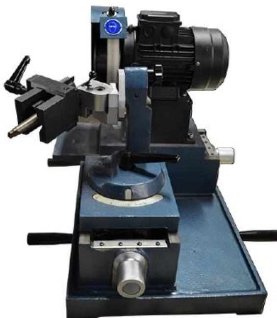
Мы изготавливаем сверлозаточный станок, на котором можно легко и точно затачивать спиральные, ступенчатые и другие сверла по металлу, дереву и даже бетону. Это уникальное предложение, потому что станок обладает максимально возможным диапазоном затачиваемых диаметров. До 80 мм.
