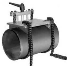
Как известно, магнитный станок крепится только на ровные магнитные материалы - стальные листы и балки. Что делать, если требуется просверлить таким станком трубу диаметром 100-300 мм? Для решения этой задачи существует адаптер для крепления станка на трубу "АКСТ-1".
