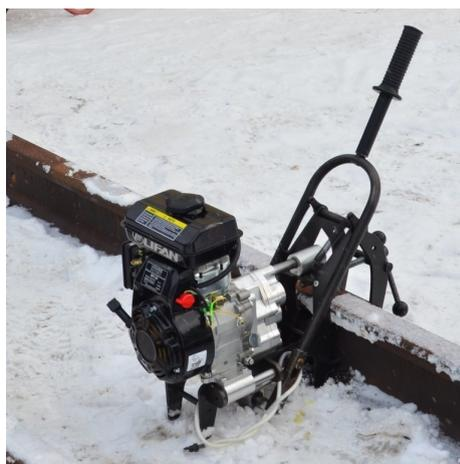
Диапазон сверления спиральным сверлом: 1-13 мм
